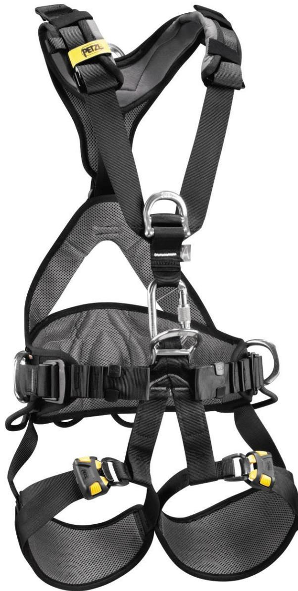
En la realización de trabajos en altura es obligatorio usar, siempre que exista un riesgo mínimo de sufrir una caída, un arnés integral anticaídas que cumpla la norma EN 361.
